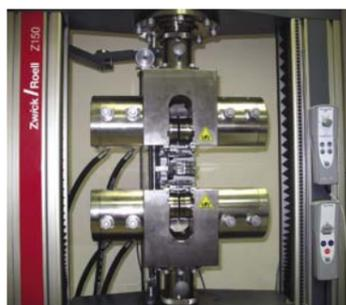
2009 – введена в эксплуатацию еще одна, более мощная испытательная машина Z150 фирмы Zwick/Roell, а также вырубной штамп для изготовления образцов в соответствии с EN 10002-1 и специальный станок той же фирмы для подшлифовки вырубленных образцов.
