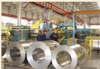
Оборудование ведущих зарубежных производителей, установленное на нашем предприятии, позволяет производить ленту (штрипс) и листы для последующего изготовления автокомпонентов с минимальными допусками и не травмируя поверхность металла. Две линии поперечной резки металла испанской компании «FAGOR» позволяет изготавливать лист не только прямоугольной формы, но также трапециевидной и ромбической, что позволяет значительно сокращать рас-
