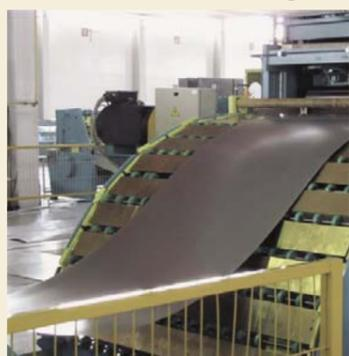
Данные виды контроля проводятся силами собственной лаборатории, использующей самое современное оборудование немецкой компании Zwick/Roell, удовлетворяющее требованиям автостандартов. В процессе порезки рулона контролируется поверхность металла на предмет наличия дефектов, определяемых заказчиком. Дополнительно при порезке измеряется шероховатость поверхности.
